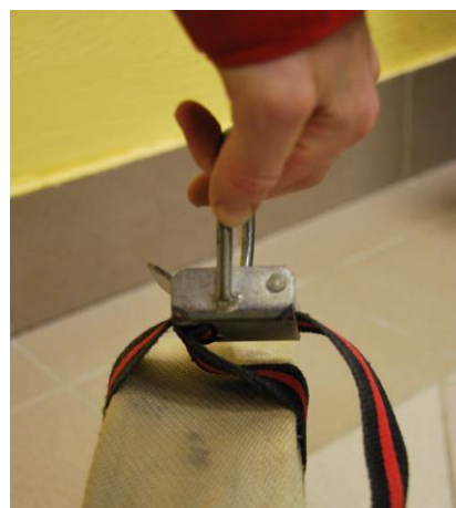
NEPRAVILNO ZAPET CEVNI NOSILEC
