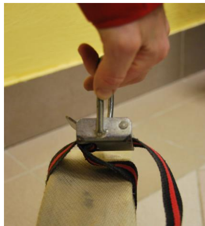
NEPRAVILNO ZAPET CEVNI NOSILEC
