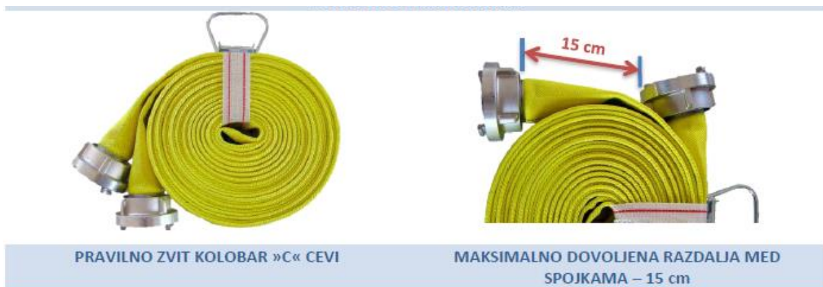
Slika 10: Prikaz pravilno in nepravilno zapetega cevnega nosilca.
